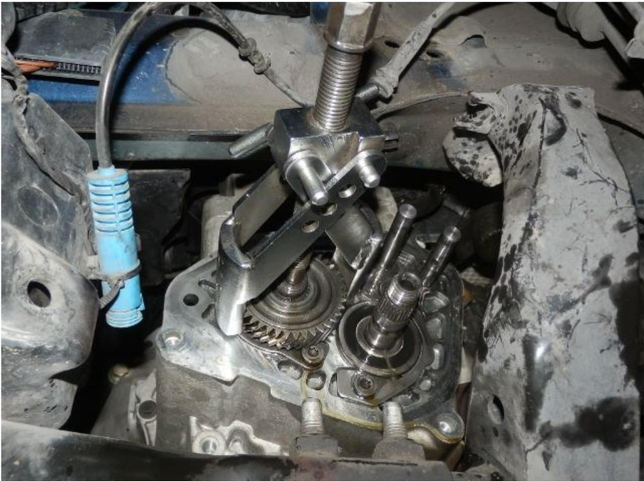
Après avoir retiré les deux vis torx (freinées au Loctite) et la plaquette de bridage, je profite de la gorge sur la cage extérieure de roulement pour placer un extracteur (encore plus gros) et commencer à tirer sur le roulement... qui résiste 😞 Une fois l'extracteur en tension, je frappe avec un maillet sur la vis et là, le roulement commence à venir 😊 Je remets en tension et répète l'opération plusieurs fois jusqu'à ce que ça sorte.
