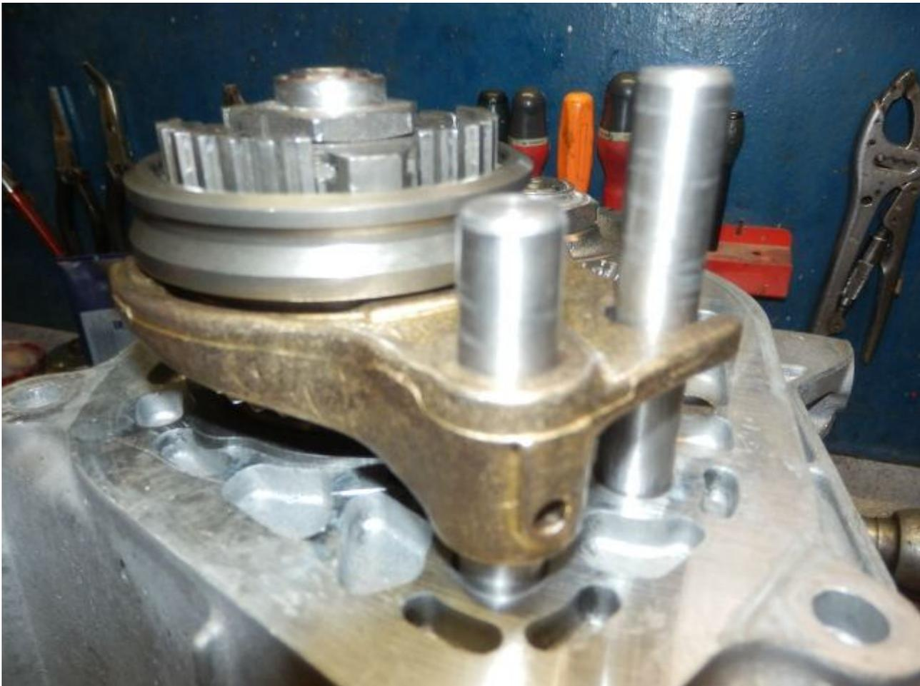
L'écrou de l'arbre secondaire (synchro) doit être monté au frein filet. Pour serrer les deux écrous à 13 m/kg (130 Nm), il faut immobiliser les arbres en rotation. Pour cela, on engage une vitesse (n'importe laquelle) avec le levier de commande et on engage une deuxième vitesse, en l'occurrence la 5ème, en faisant descendre la fourchette encore apparente. Une fois les arbres serrés, on enlève les deux vitesses et on place la dernière goupille mécanindus.
