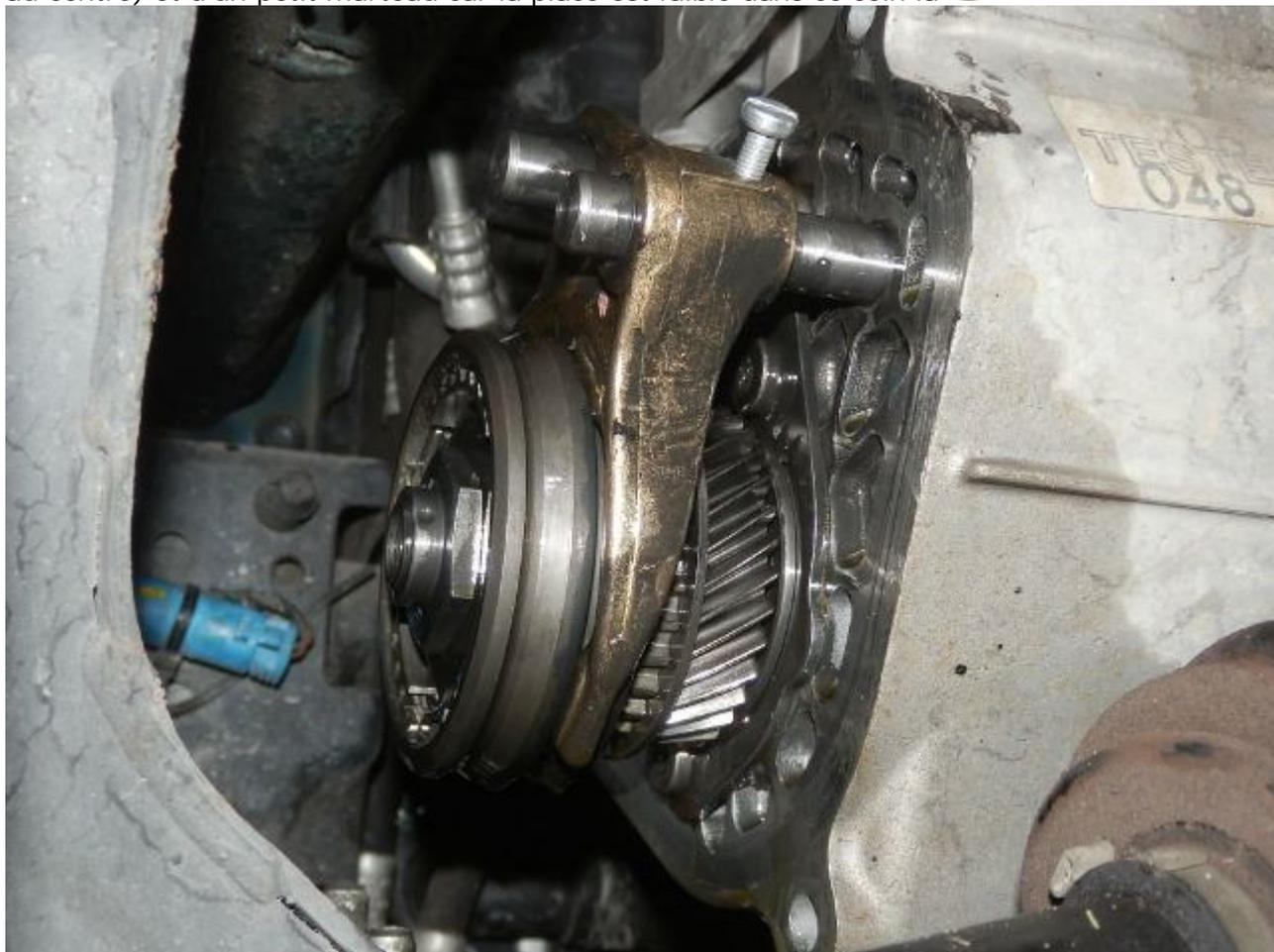
Dépose des deux écrous d'arbres de boîte à la clé à choc... mais une autre solution sera employée au remontage.
