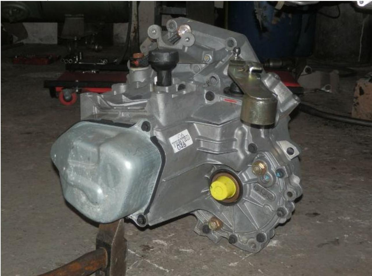
Passons aux choses sérieuses, maintenant. Je pose la boîte sur l'établi, dépose le contacteur de marche arrière et desserre toutes les vis du carter.... et là, je comprends que pour tout ouvrir, il va falloir déposer les pignons de 5ème. Donc, rebelote. Dépose du petit carter en tôle puis des pignons et du synchro de
