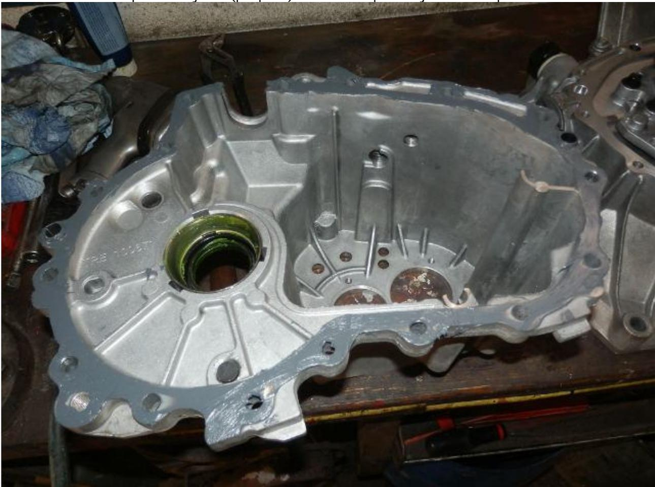
Le carter étant remonté et serré, on place les deux cavaliers de maintien des roulements et on serre les vis montées au frein filet.
