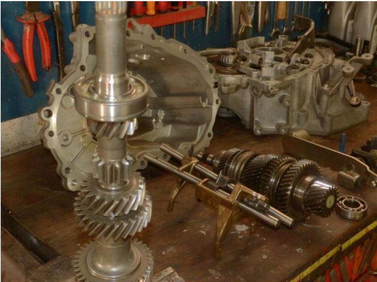
Une fois les roulements d'arbre primaire montés, on peut le remettre en place. Ici, il est dans son logement mais pour reposer les deux arbres, il faut l'engager sans le laisser descendre au fond de son logement, ce qui permet de le laisser un peu en travers.
