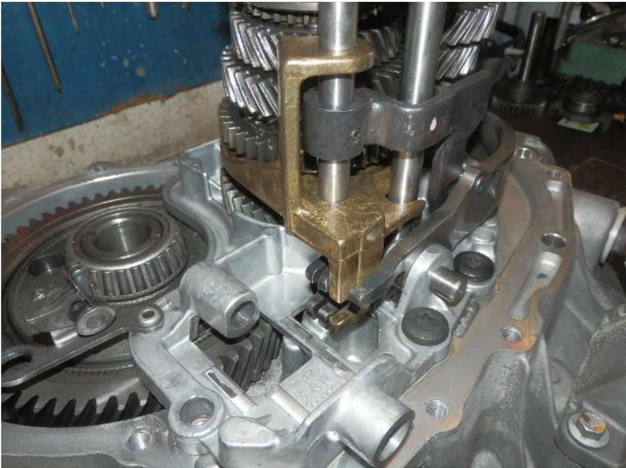
On repose dans l'ordre, l'interdiction (pièce en U retournée), le ressort accompagné de ses deux rondelles en plastique et enfin le doigt de commande (dans le U retourné). Une fois le montage réalisé, on peut engager l'axe et son levier de commande (celui qui sort de la boîte) en ayant bien sur monté son caoutchouc d'étanchéité. Il ne reste plus qu'à remettre la goupille mécanindus de blocage.
