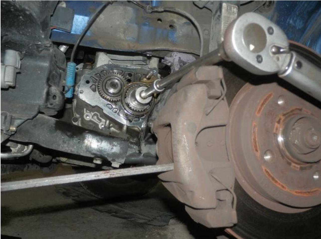
Une fois les écrous serrés à 10 et 12 m/Kg (ce qui me semble une valeur correcte), j'ai freiné ceux-ci avec des coups de burin aux endroits prévus, puis remontage du carter et remplissage avec 2 litres d'huile neuve.
