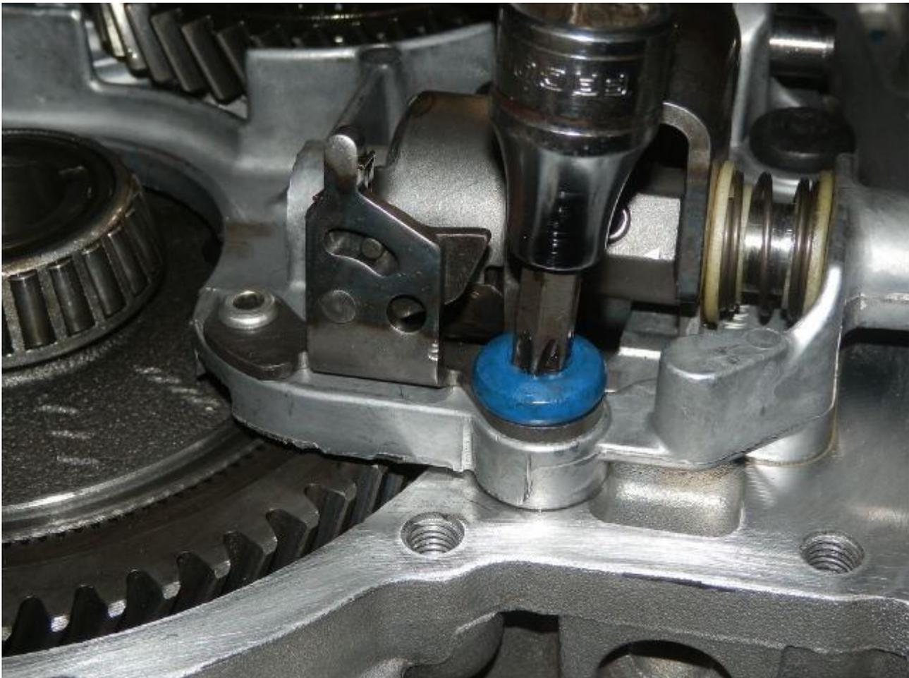
Si toutes les vitesses passent bien, on contrôle le bon positionnement de l'axe du pignon fou de marche AR qui ne doit pas pouvoir tourner puisque le méplat doit coïncider avec le logement du carter. On enduit l'un des plans de joint (propres) avec de la pâte à joint et on peut refermer la boîte.
