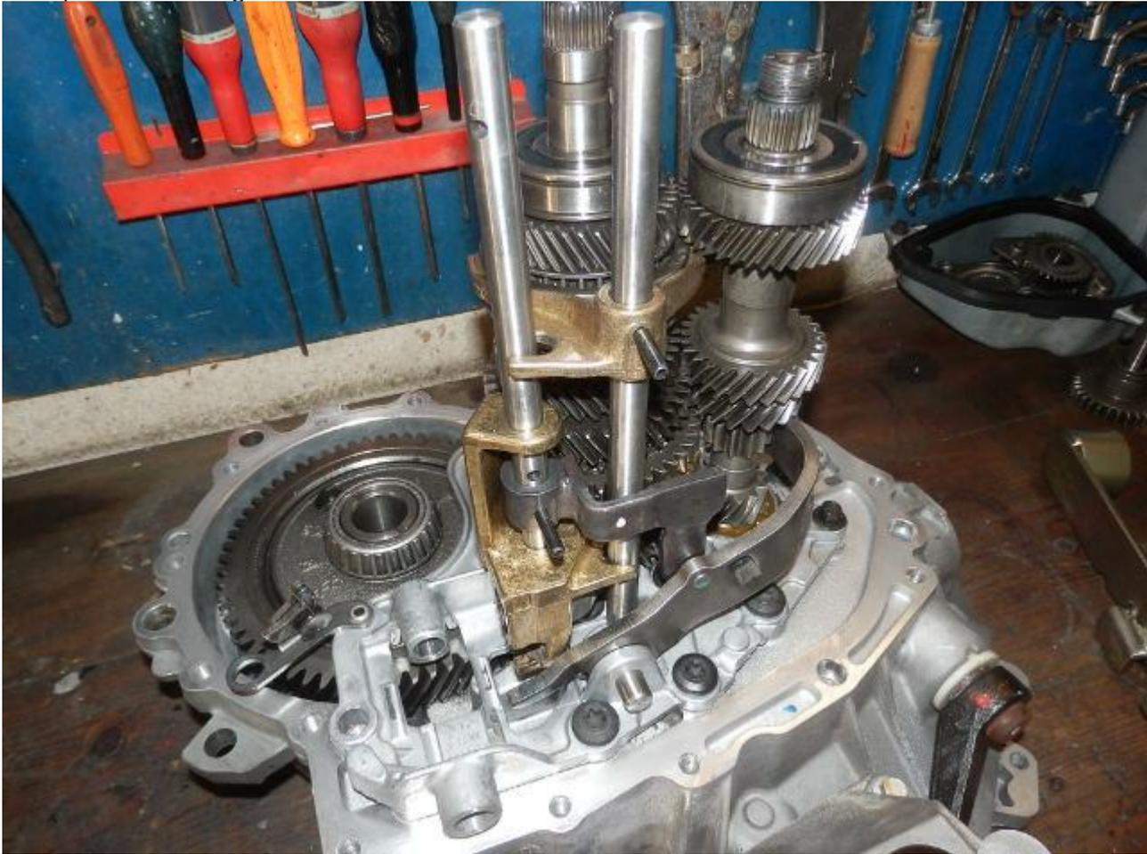
On peut maintenant monter les deux goupilles mécanindus (une sur le la fourchette de 3ème/4ème et l'autre sur le levier de commande de marche AR) et rendre les fourchettes solidaires des axes.
