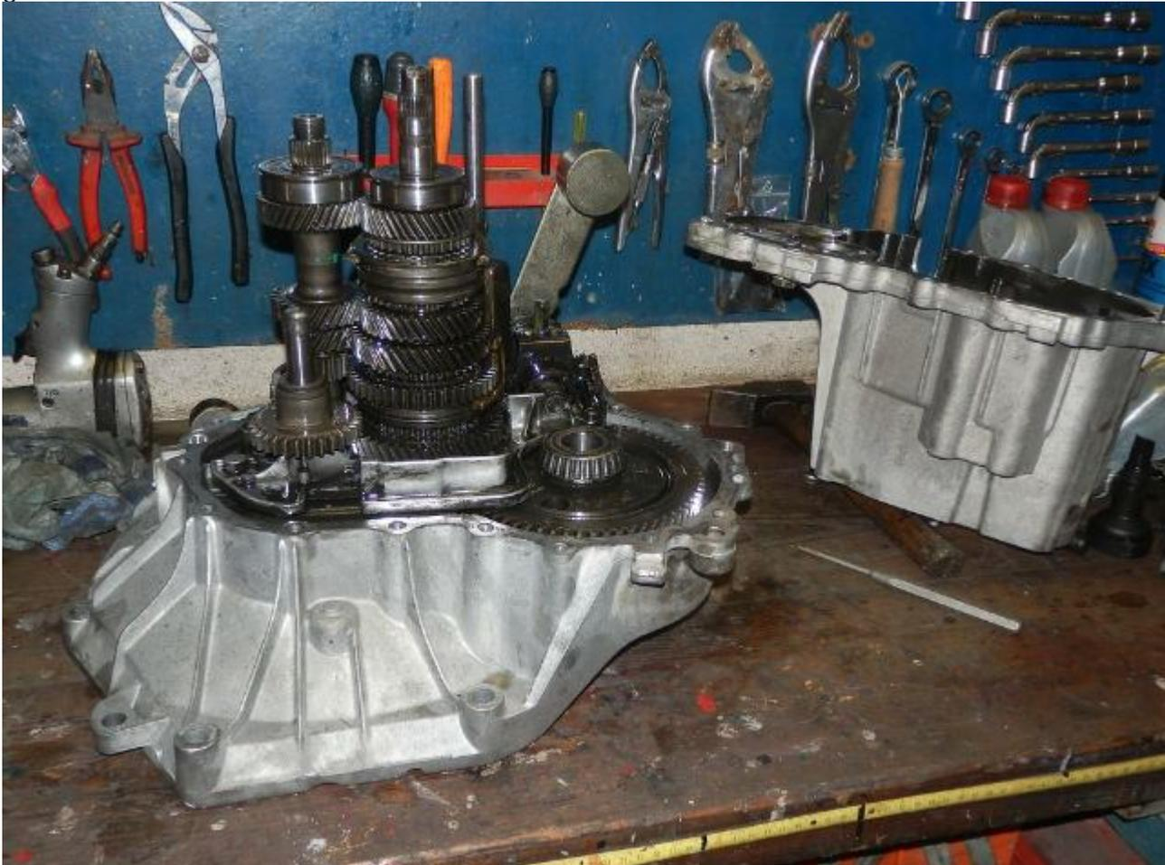
Le pignon de marche arrière en bas à gauche, l'arbre moteur en haut à gauche, l'arbre récepteur à sa droite et le pont en bas à droite. Voilà, les présentations sont faites.
