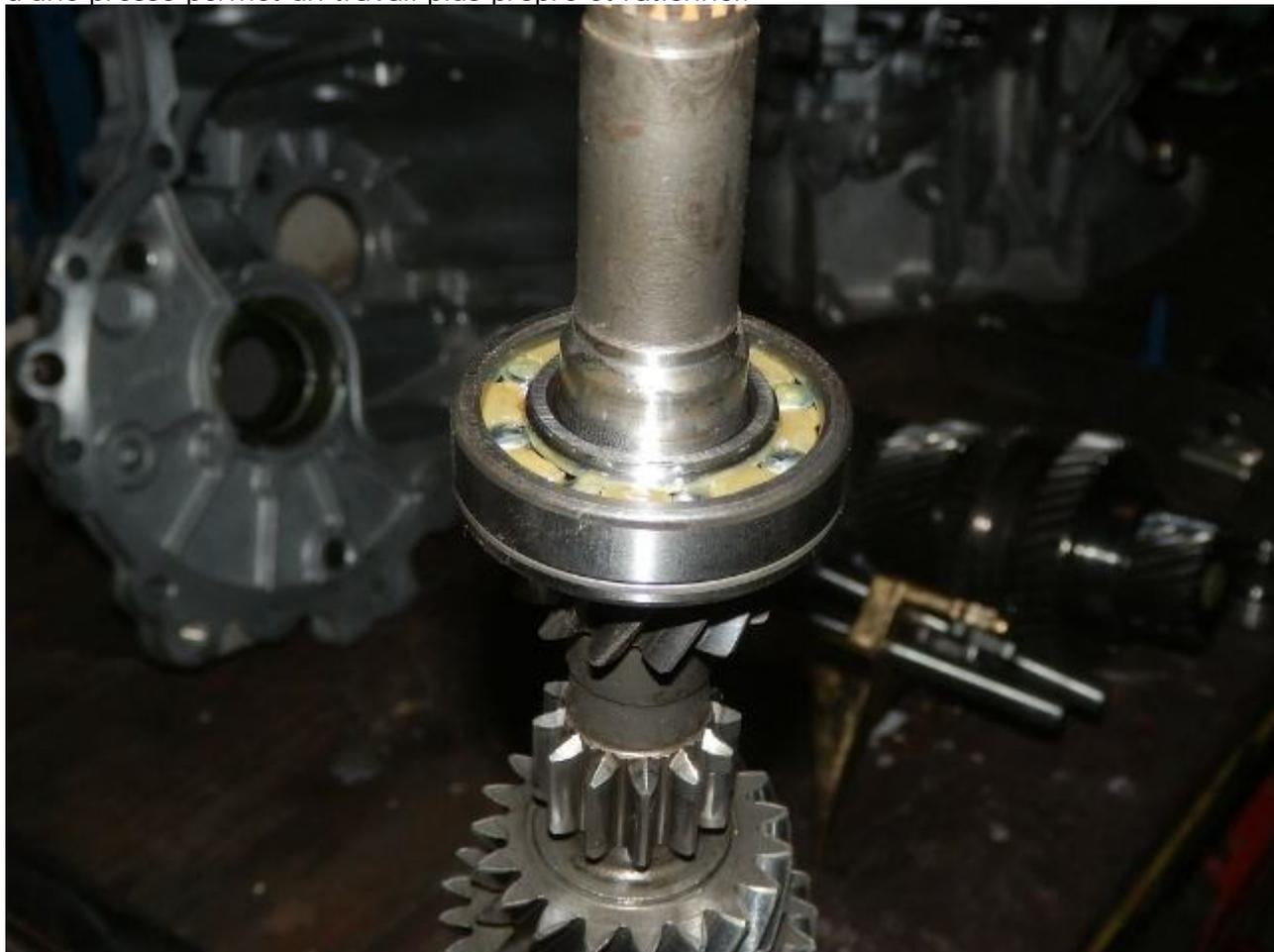
Au passage, une petite vue d'ensemble qui permet de remarquer que les axes et fourchettes sont imbriqués les uns dans les autres. Autrement dit, il faut les assembler avant de les monter sur l'arbre secondaire qui est posé juste derrière.
