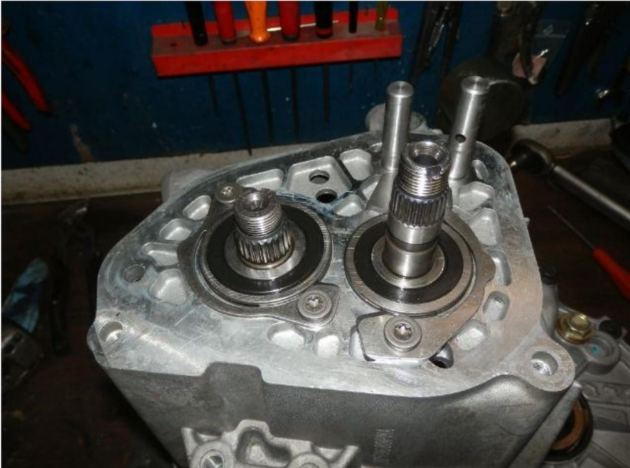
On repose le pignon fixe de 5ème en orientant la rainure périphérique vers le haut. Ce pignon est monté légèrement serré sur les cannelures. On place ensuite, la rondelle, le roulement à aiguilles, le pignon mené de 5ème puis le synchro avec sa fourchette. Par contre, il ne faut pas monter la goupille mécanindus.
