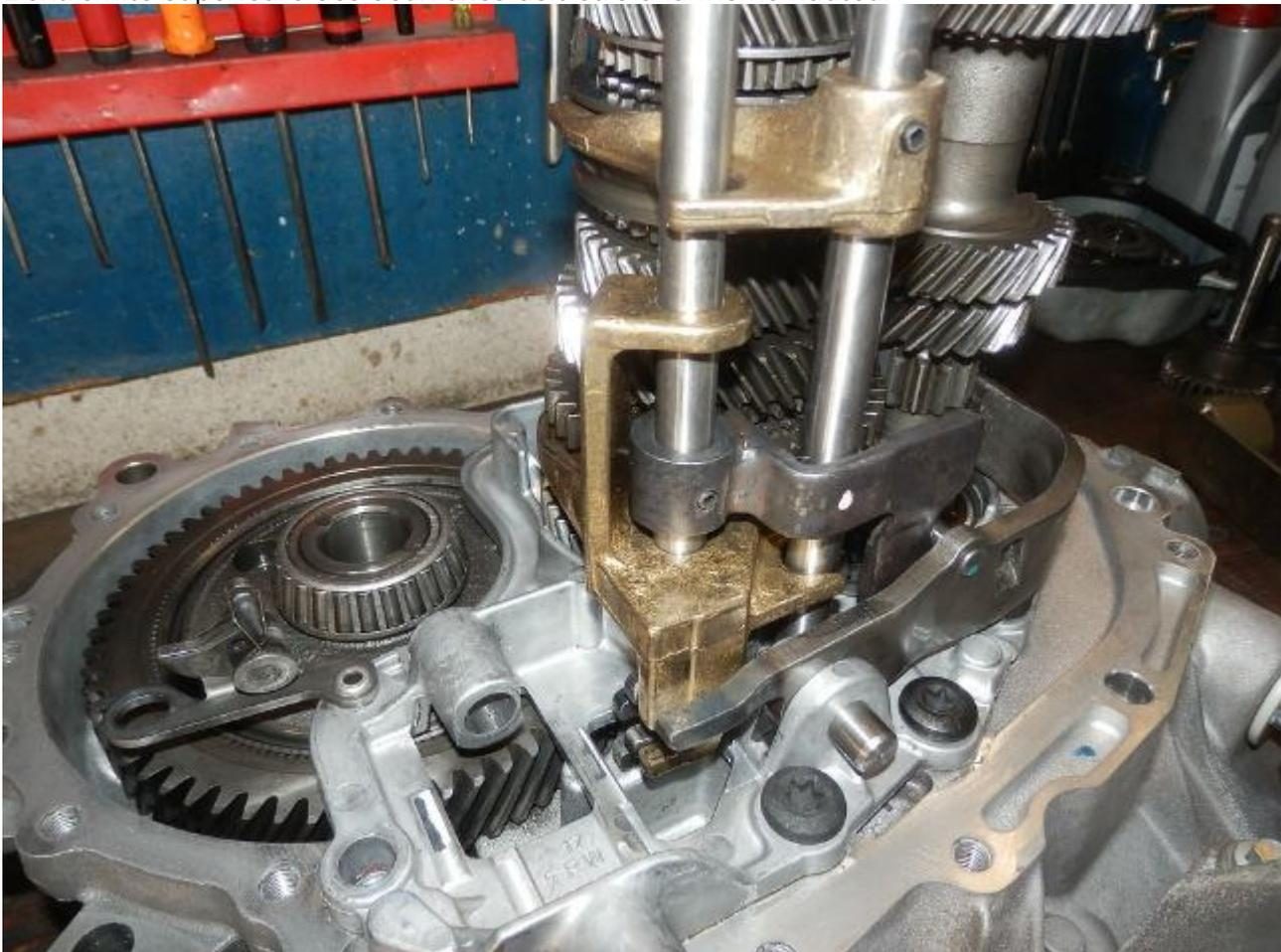
On met maintenant la boîte au point mort en alignant les 3 couloirs de commande (au centre de la photo). L'extrémité supérieure des deux axes doit être à la même hauteur
