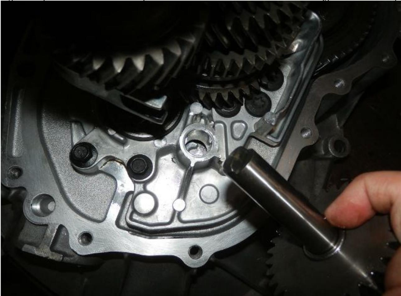
On finit avec le truc dont je n'ai pas réellement analysé la fonction et sa grosse vis torx. Maintenant, il faut vérifier que toutes les vitesses passent bien, y compris la marche AR. Pour cela, il faut faire pivoter le levier extérieur dans les 3 couloirs (neutre, poussé et tiré).
